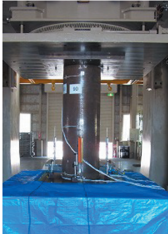
写真 1 圧縮実験状況 Photo 1 Short pillar compression test
